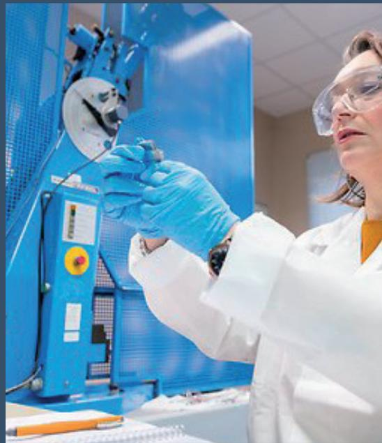
Apprécier par micro-épreuve la qualité de l'acier d'une canalisation. Développée avec Total et Mines ParisTech, cette méthode permet d'estimer rapidement le risque d'un défaut détecté dans une canalisation en ne prélevant qu'un copeau d'acier en surface. Le tronçon affecté ne sera remplacé qu'en cas de risque avéré. Moins coûteuse que le remplacement systématique, cette solution présente aussi l'avantage de réduire les indisponibilités du réseau.
